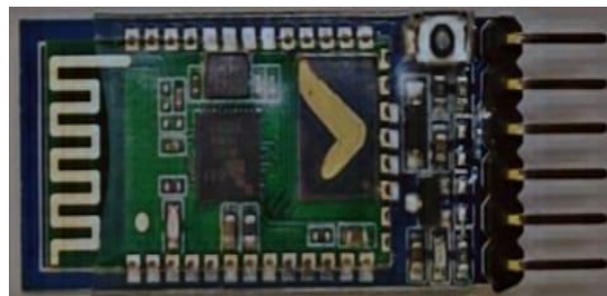
Fig. 2 : Bluetooth module (HC-05)
