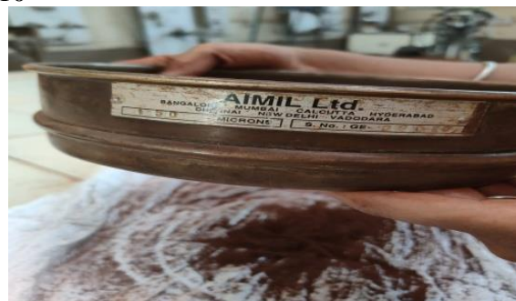
Fig-2 Sieve Analysis Red Mud of 150 Micron.
